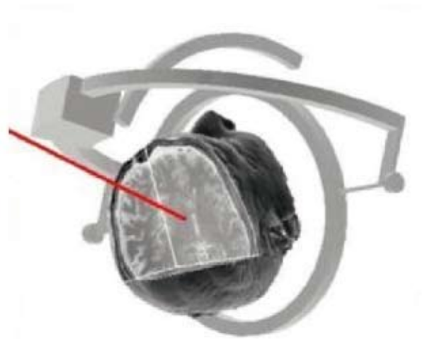
Schematische Darstellung des Patientenkopfes, des stereotaktischen Rings sowie der Zielbogenvorrichtung.
